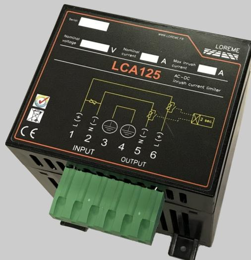
Le LCA125 est un limiteur de courant actif avec un relais by-pass temporisé assurant un fonctionnement plus efficace qu'une simple CTN, il coupe les pointes de courant dans la charge lors du démarrage des installations et ne dissipe aucune puissance en fonctionnement.
